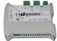
Bei vielen umgerüsteten Fahrzeugen müssen Steuerfunktionen, die vom Motorsteuergerät des ursprünglichen Antriebs bereitgestellt wurden, von der E-Car-Box übernommen werden. Dies geschieht meist über den Fahrzeug-eigenen CAN-Bus. Um diesen galvanisch und logisch von der E-Car-Box zu trennen, ist es erforderlich, ein **CAN-Gateway** einzusetzen. Das Gateway wird hierzu von E-Car-Tech fahrzeugspezifisch programmiert.
