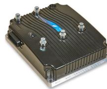
Konfigurierbare **Controller** für das gesamte Fahrzeug-Management in einer Leistungsklasse von 24V bis 144V und von 300A bis 800A. Durch zusätzlich erhältliche E-Car-Tech-Softwaremodule können weitere Fahrzeugfunktionen abgerufen bzw. beeinflusst werden. Die Parametereinstellungen erfolgen entweder über den optional erhältlichen Handprogrammierer oder per PC-Schnittstelle.
