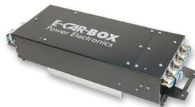
Die **E-Car-Box** ist das Herzstück des Elektroantriebs. In ihr sind alle wichtigen Komponenten zur Ansteuerung des Motors platzsparend, sicher, und EMV-konform eingebaut, und nach höchsten Sicherheitsstandards verkabelt. Sie enthält neben dem Controller zur Ansteuerung des Motors auch den Hauptschütz, einen DC-DC-Wandler, sowie alle erforderlichen Hoch- und Niederspannungssicherungen.
